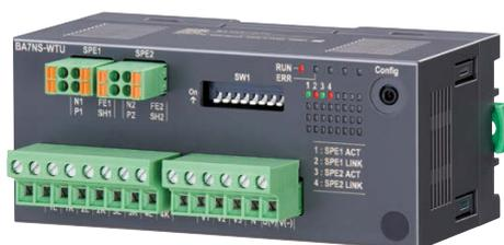
電力マルチ変換器（形式：BA7NS-WTU）は、三相4線式の結線に対応した小形電力変換器です。単相は4回路、単相3線と三相3線は2回路まで計測できます。SPE（10BASE-T1L）のポートを搭載し、メタトロン®コンバータ（形式：BA8NS-CONV）を経由してModbus/TCPで接続できます。
