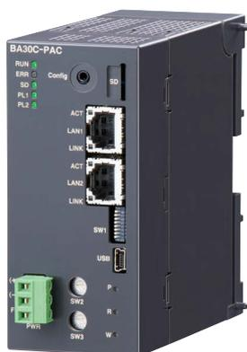
メタトロン®コントローラ（形式：BA30C-PAC）は、ネットワークに接続されたりリモートI/O製品の情報を、ポイントとして管理し、状態/警報監視、発停、週間スケジュール運転などの各種機能により省力化に貢献します。
