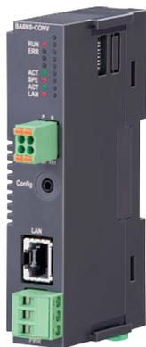
メタトロン®コンバータ（形式：BA8NS-CONV）は、イーサネットの最大伝送距離を1000mまで延ばすことができる便利なネットワーク変換器です。Modbus/TCPとメタトロン®のプロトコルを相互に変換します。4対のツイストペアケーブルで構成されるLANケーブルは太くて重く、高価なものですが、メタトロン®コンバータは1対のツイストペアケーブルで通信できるので、細くて軽量、安価を実現できます。
