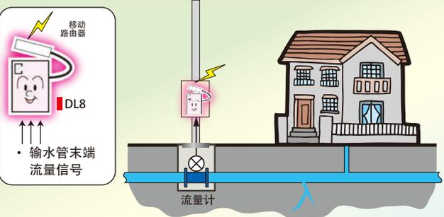
通过对输水管末端流量计进行连续测量，可以发现漏水部位。
