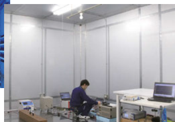
宽敞(6m×6m)的屏蔽室，可同时进行多项试验
