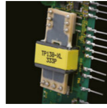
薄板式变压器 通过绕组线圈为印刷电路板结构的超薄板式变压器，在不占空间的情况下实现了隔离强度2000V AC。
