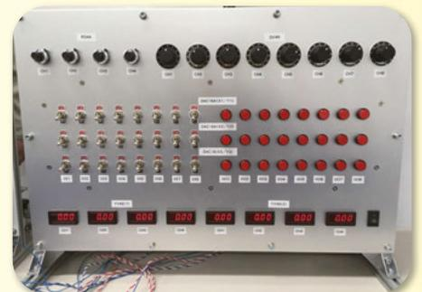
数字量、模拟量输入输出模拟器
