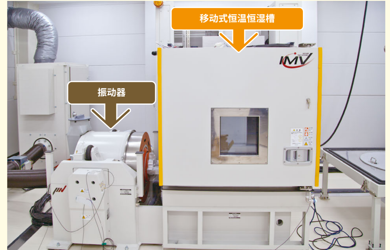
2014年6月，本公司京都技术中心引进了温湿度振动复合环境模拟系统。该系统带有恒温槽，可在温度为-40°C ~ 140°C、湿度为20% ~ 90%RH的严酷环境中进行垂直和水平振动试验。
