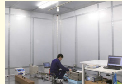
宽敞(6m×6m)的屏蔽室，可同时进行多项试验
