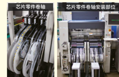
将约350种零件集中安装在转向架上，无需切换工序即可生产不同产品。
