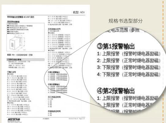
第1报警输出选择代码2的上限报警时，正常时输出继电器励磁，报警时继电器非励磁。如果报警器因系统异常或停电而断电，即使为正常值也会输出报警，检测到系统和报警器的异常。
