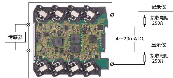
M6系列的电流输出的容许负载电阻为550Ω（4~20mA DC时）。
