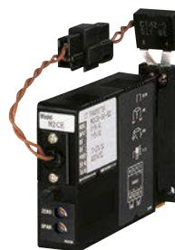
将交流电流信号转换为仪表标准信号。电机的冲击电流等有可能导致小型底座发生熔敷，因此输入信号会迂回底座。
