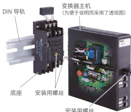
采用小型插拔式构造，进行检查、更换时无需拆卸接线。底座和变换器主机使用安装用螺丝牢固固定，不用担心发生松动或脱落。
