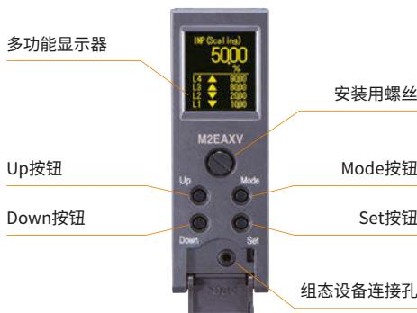
可用位于前端面上的Up/Down/Mode/Set按钮变更规格。
