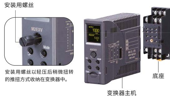
采用小型插拔式构造，进行检查、更换时无需拆卸接线。底座和变换器主机使用安装用螺丝牢固固定，不用担心发生松动或脱落。
