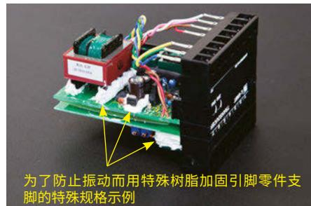
为了防止振动而用特殊树脂加固引脚零件支脚的特殊规格示例
