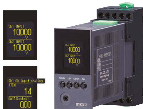
推出了采用高辨识度有机EL显示器的M1E系列。具备输入缩放、回路测试、报警测试、线性化等功能，可以一边确认有机EL显示器上的这些参数，一边用前端按钮进行设定。
