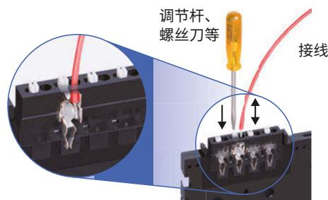
用调节杆、一字螺丝刀等按下用于插拔电线的白色凸起后插拔电线。金属箍等前端较硬的电线可以直接插入。
