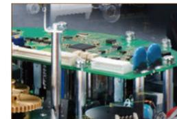
采取了分离发热的电机控制电路板和电子电路，提高电机控制电路板散热效率的散热措施。
