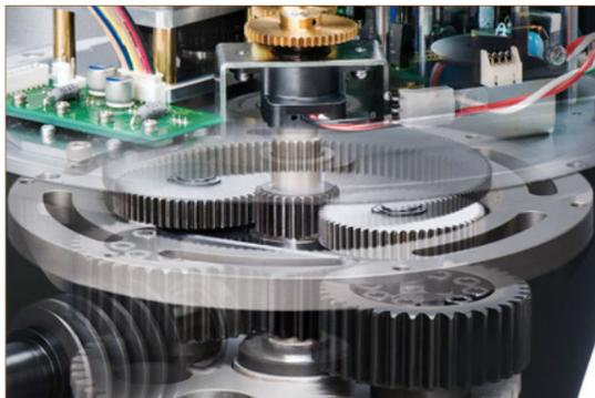
行星齿轮机构就像行星绕着太阳及其周围公转一样，在中心的太阳齿轮旋转的同时，其周围的2个行星齿轮一边旋转（自转），一边在太阳齿轮的周围旋转（公转）。而且，2个行星齿轮由带输出轴的行星齿轮架连接，利用行星齿轮架的旋转带动行星齿轮机构的输出轴旋转。行星齿轮机构与由平面齿轮组成的齿轮机构相比，能以较少的齿轮数量得到较大的扭矩，实现小巧且齿隙较小的齿轮机构。
