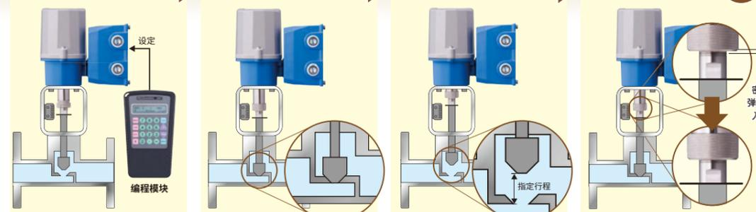
将MSP40组装到阀上，只需通过编程模块 (机型: PU-2A) 指定行程和输入下降侧密封弹簧的压入量。
