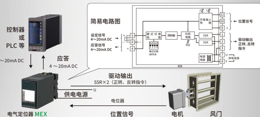
比较来自控制器和 PLC 的设定信号与来自位置传感器的位置信号，通过操作、控制 SSR 和 24V AC 干接点，使二者保持一致。
