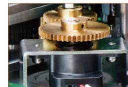
采用与装配在工业车辆和建设设备同类的电位器，实现了抗振性、高品质及长寿命。
