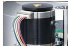
驱动部采用了非接触结构的长寿命步进电机。以每接收1个脉冲接收1.8度步距来控制电机的转动，能够进行高精度的开度控制。
