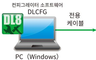
컨피그레이터 소프트웨어(형식:DLCFG)를 설치한 PC를 전용 케이블(형식:COP-US별매)로 DL8 본체에 연결해서 모든 항목을 설정합니다.
