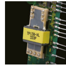
시트 트랜스 코일을 PCB 기판화하여 슈퍼 슬림 타입으로 만든 시트 트랜스를 통해 공간을 많이 차지하지 않는 내전압 2000V AC를 실현했습니다.
