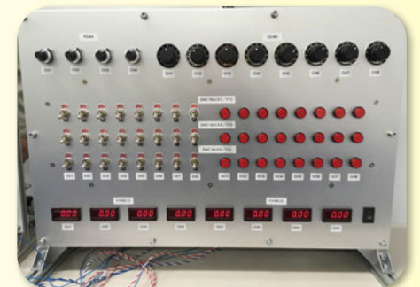
디지털 및 아날로그 입출력 시뮬레이터
