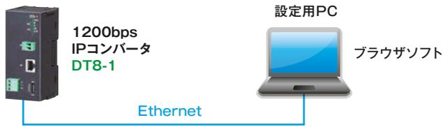
ブラウザソフトを起動して、アドレスにIPコンバータの工場出荷時設定値のIPアドレス192.168.0.1と入力します。ユーザ名とパスワードを入力してログインすると、設定メニューが起動します。
