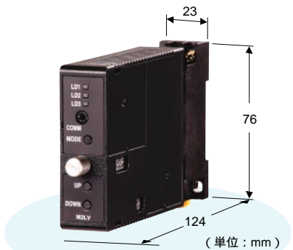
図1 M2LV、M2LPM、M2LRの外観と寸法
