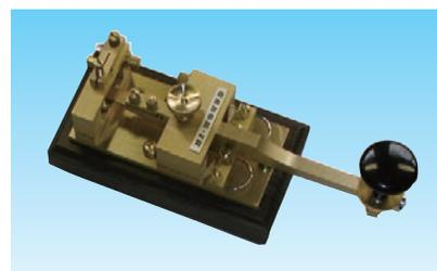
図3 モールス信号を打電する電鍵
