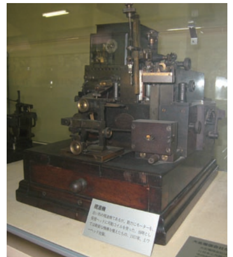
図1 サイフォンレコーダ (現波機、幅40cm、ミラーヘッド社(1907年製)) (写真: KDDI(株)提供)
