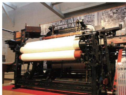
図4 無停止杼換式自動織機(G型)1号機
