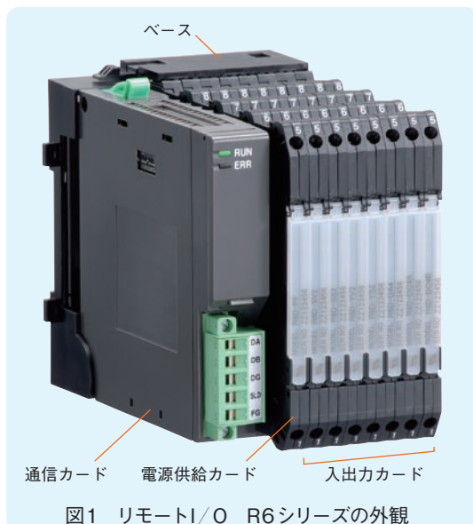
図1 リモートI/O R6シリーズの外観
