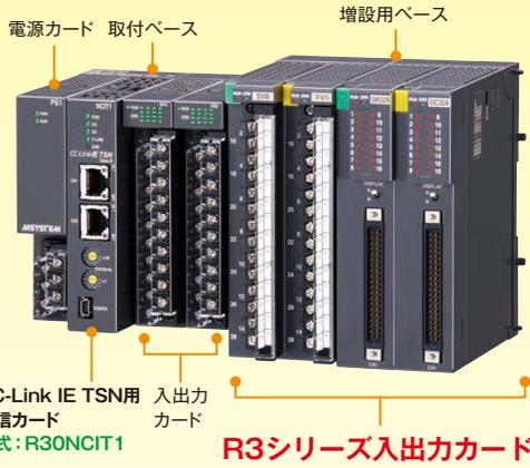
R30シリーズの取付ベースは、経済性が高く、入出力カードの種類が豊富なエム・システム技研の多チャンネル組合せ自由形リモートI/O R3シリーズのベース部とコネクタで連結できる構造になっています。連結することで、R3シリーズの入出力カードを使用することができます。
