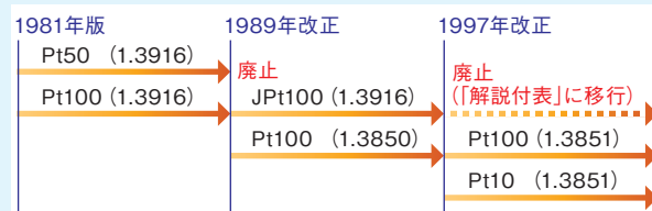
図1 JIS C1604 測温抵抗体の変遷 ( ( ) 内数値は、 R_{100}/R_0 を示す)
