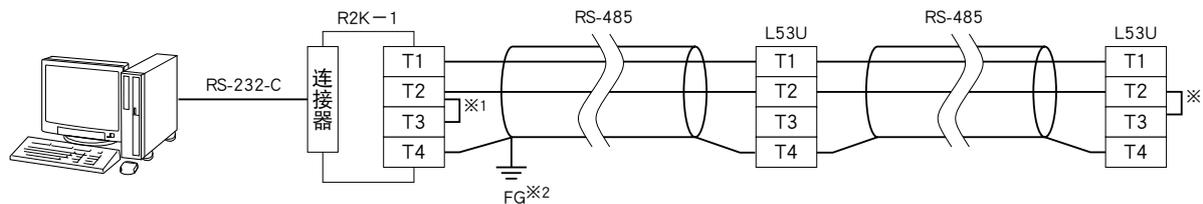
※1、设置在电路的终端时使用内部终端电阻。
