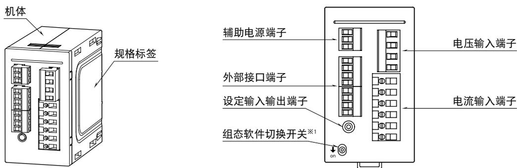
※1、只有无附加代码「/A」的产品带有组态软件切换开关。
