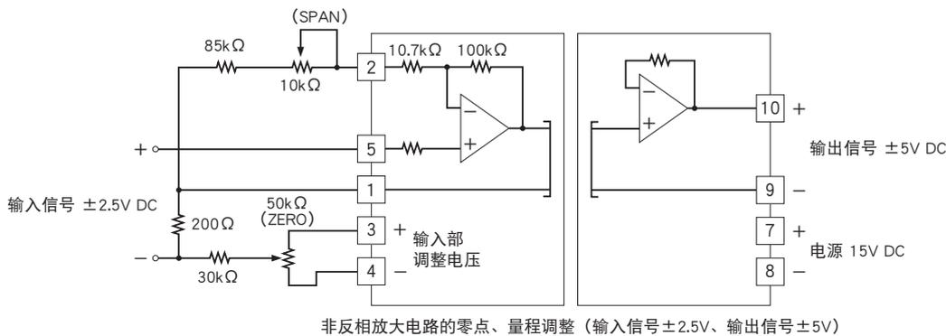
■反相放大外部调整电路: 零点、量程调整电路例  $G = -1$  (输出将输入反相输出)
