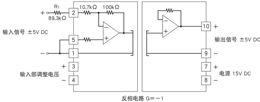
■非反相放大电路: 电路例  $G = 1 + 100k\Omega / (10.7k\Omega + R_1)$
