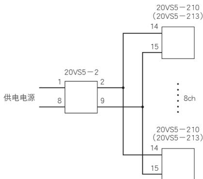
外部同步电源20VS5-2可驱动8台的20VS5-210或20VS5-213。
