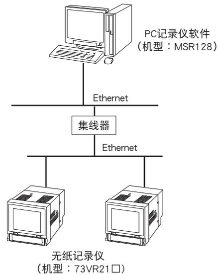
注) 73VR21□与电脑的Ethernet连接时, 建议您用直通型电缆线通过集线器进行连接。
