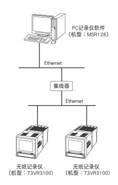
注) 73VR3100与电脑的Ethernet连接,推荐通过集线器用直通型电缆线进行连接。
