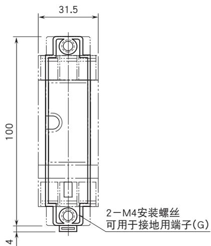
· 安装3线型避雷器时的安装距离为31.5mm
