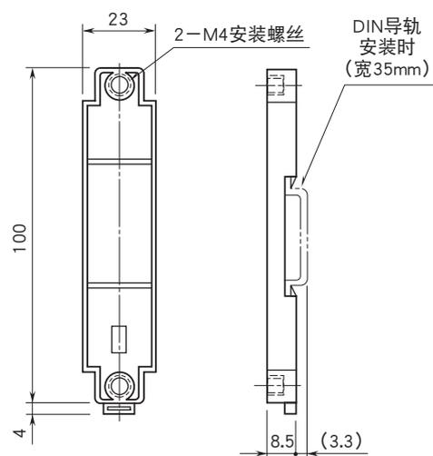
安装尺寸图 (单位: mm)
