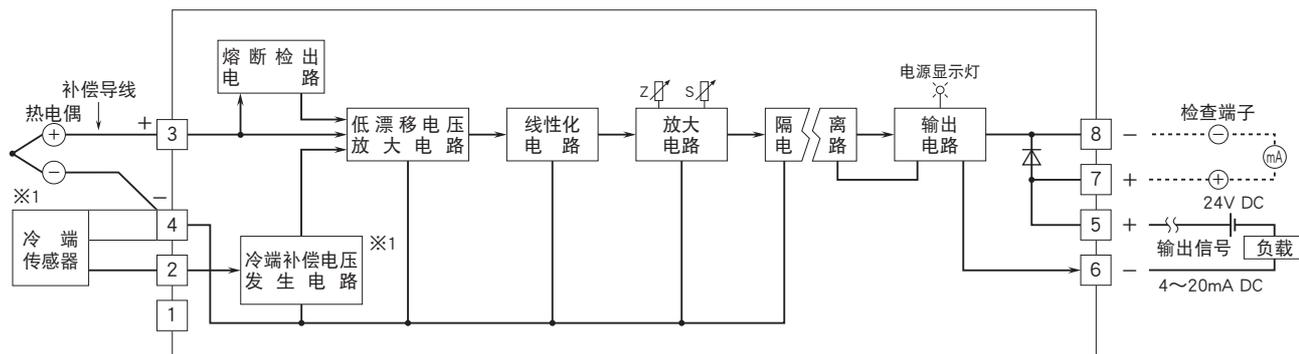
※1、输入信号为B热电偶时无冷端补偿电压发生电路。
