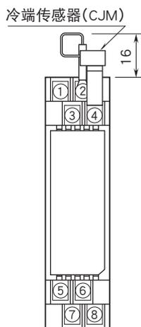
简易电路图·端子接线图
