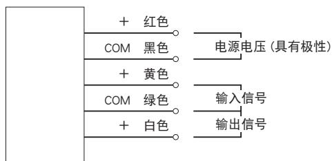
电源的COM端与输入输出信号的COM端相连，因此连接交流电源时请确保正确连接。
