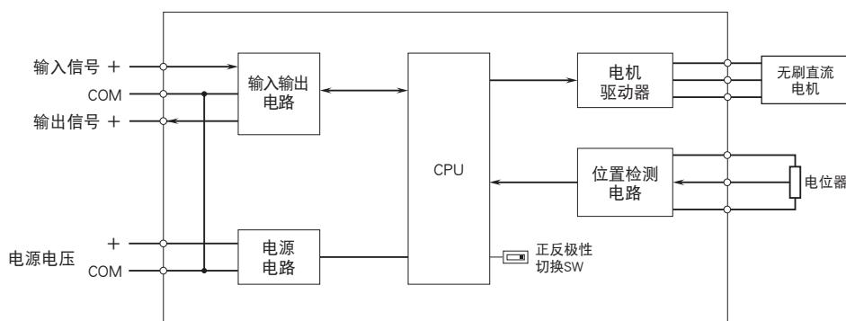
电源的COM端与输入输出信号的COM端相连，因此连接交流电源时请确保正确连接。
