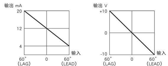
输入电压为无电压或输入电流为额定的5%以下时, 输出近似相角0°。
