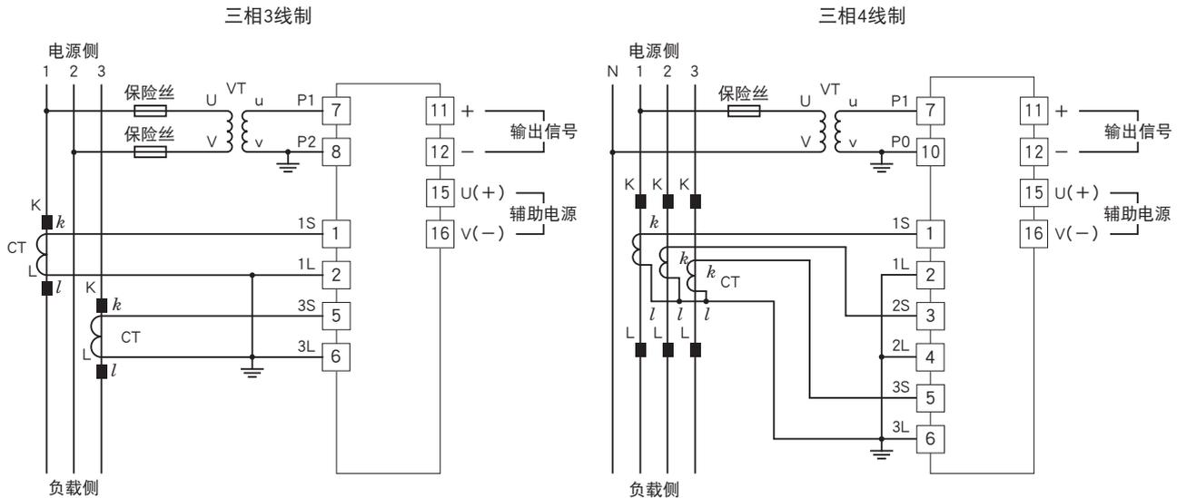
当输入电压比较稳定, 且在规格书及使用说明书所记载的辅助电源电压范围内时, 可以用输入电压信号供电。
