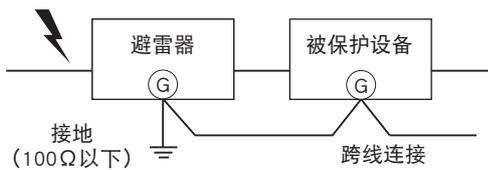
如上图所示，避雷器的接地端与被保护设备的外壳接地端之间要用跨线连接起来。
