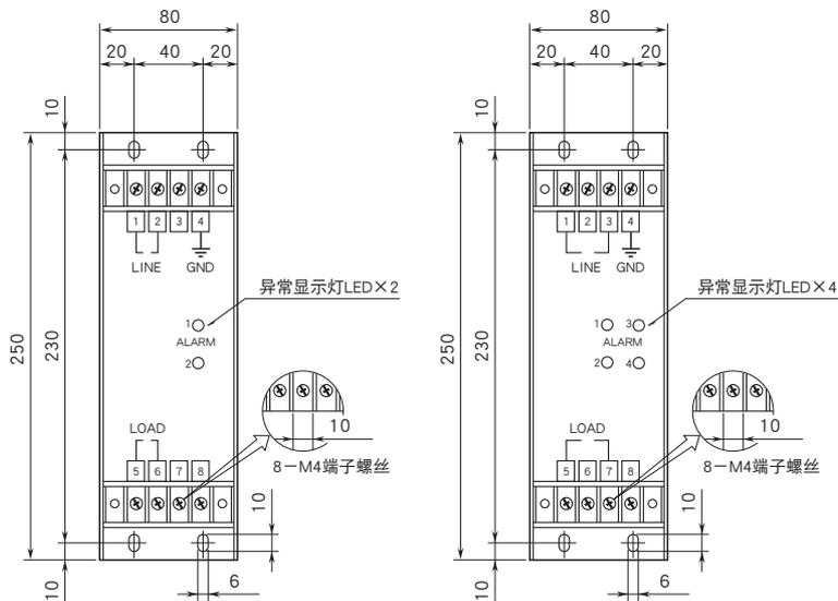
安装尺寸图 (单位: mm)
