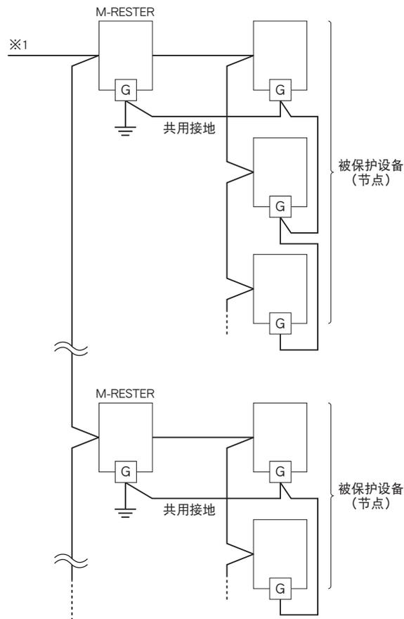
※1、符合IEC 61158-2标准的PROFIBUS设备被要求可在9~32V DC之间工作。通过总线的电流过大时，要考虑避雷器的串联电阻，再决定布线距离。
