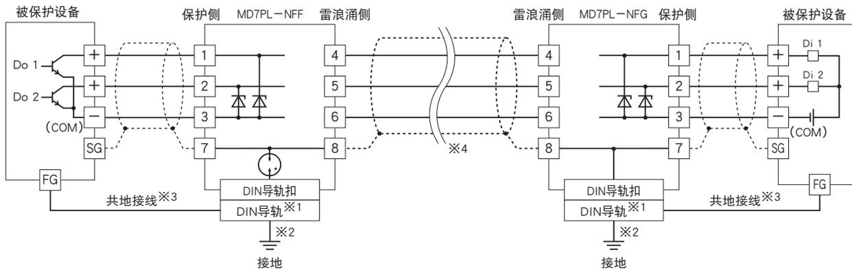
※1、铝制DIN导轨的表面氧化现象将会影响本机器与接地之间的导电性。请使用铁制或铜制的导轨。
