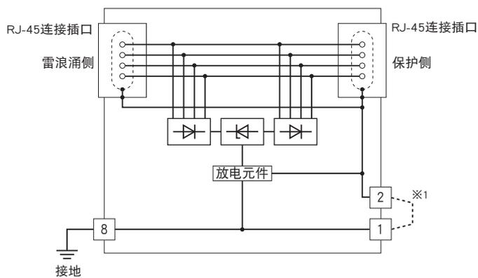
※1、LAN电缆的屏蔽线不进行接地时，请取下短接片。
