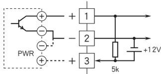
■2线制电流脉冲输入
