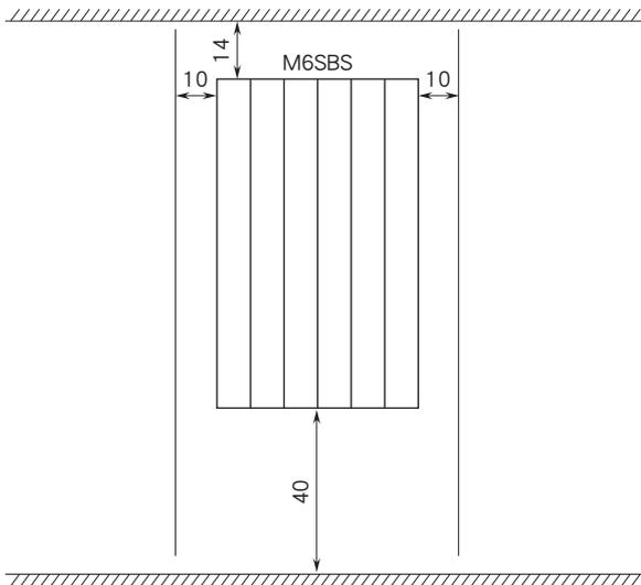
盘的底板、线路导管 (高度50mm以下)。
