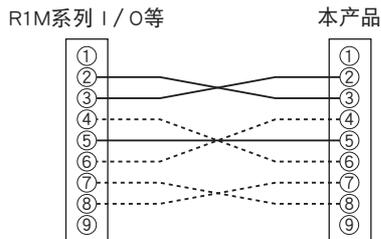
上图中的实线和点线连接是使用“Interlink”电缆线的连接例。
