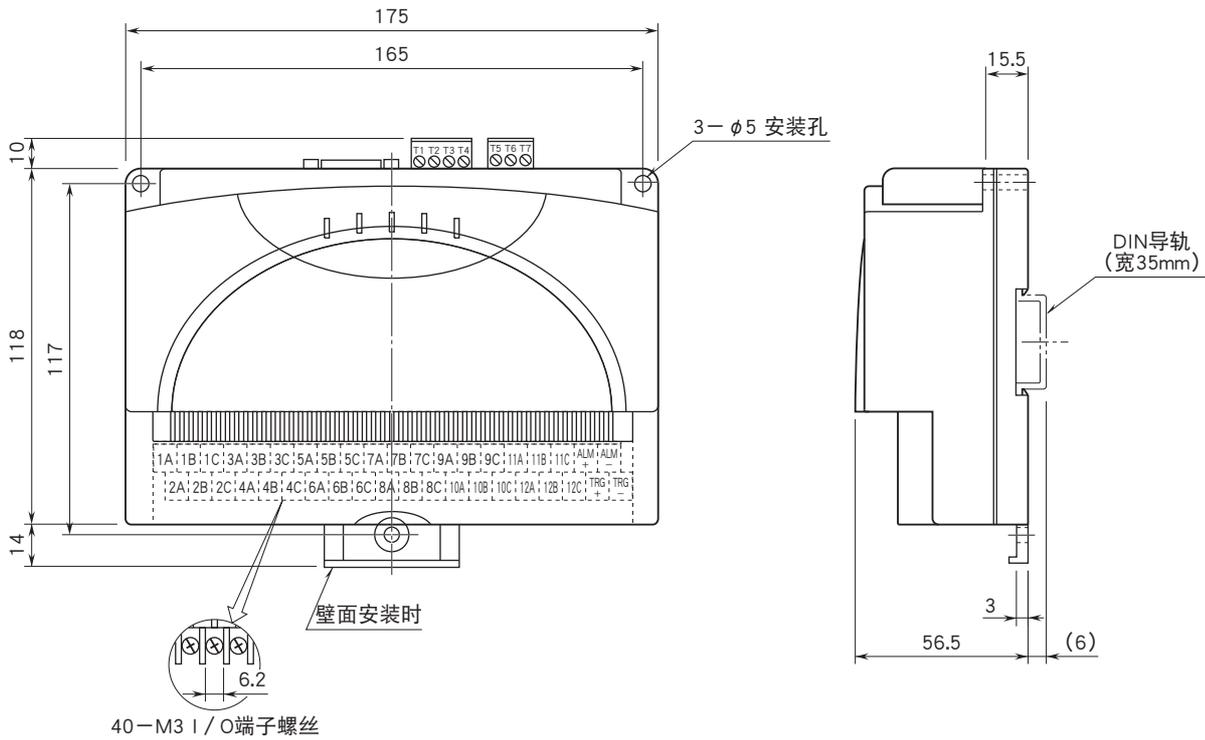
注：安装在垂直的DIN导轨上时，由于重力会有滑落的可能性，建议您使用防滑工具。例如欧姆龙生产的端板（机型：PFP-M）、IDEC生产的固定件（机型：BNL6）等产品。
