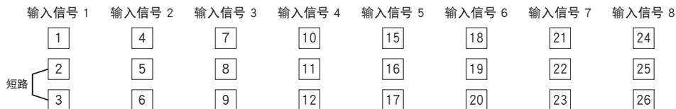
如果没有短接输入端子，输入将会不稳定。
