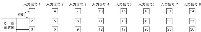
如果没有短接未使用的输入端子，ERR显示灯将会亮红色灯，PLC等主站设备显示为熔断状态。
