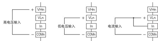
注) 输入直流电流时请务必短接端子 [VLn] 和 [In]。
