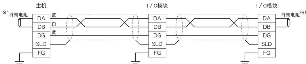
※1、终端的两个模块必须连接附带的“终端电阻”，且连接在“DA”和“DB”之间。
