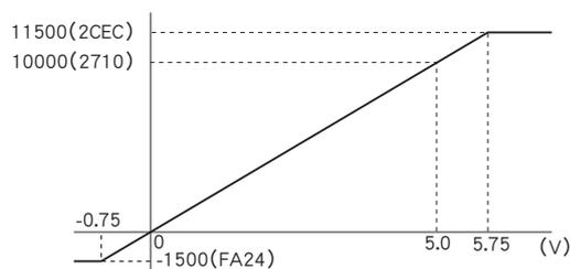
模拟量输出与输入的转换正相反, 输出范围为0~5V DC时, “10000”转换为5.0V (100%)、 “0”转换为0V (0%)的输出。
