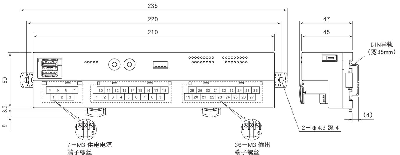
安装尺寸图 (单位: mm)
