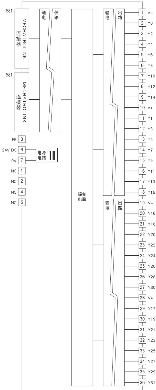
※1、MECHATROLINK连接器是内部连接, 因此通信电缆线可连接在任一处。
