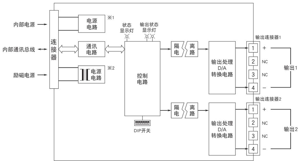
※1、与内部电源非隔离的用于控制电路的电源。
