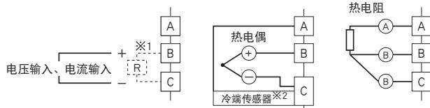
※1、电流输入时请安装电阻器(机型: REM4)后使用。
