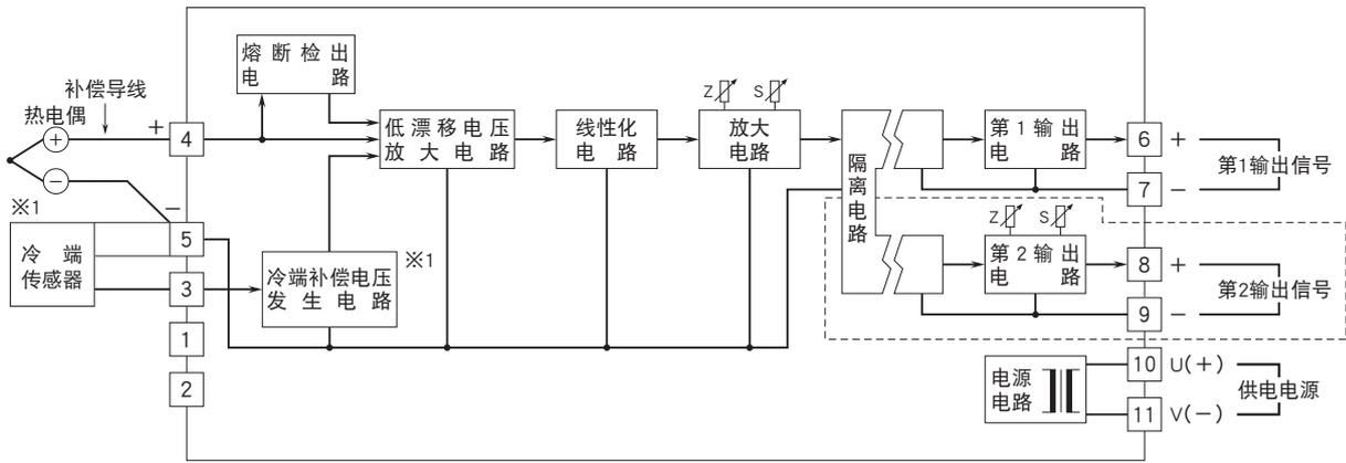
※1、输入信号为B热电偶时不附带冷端传感器。
