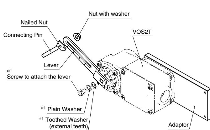
**■ ATTACHING & ADJUSTING THE LEVER**
