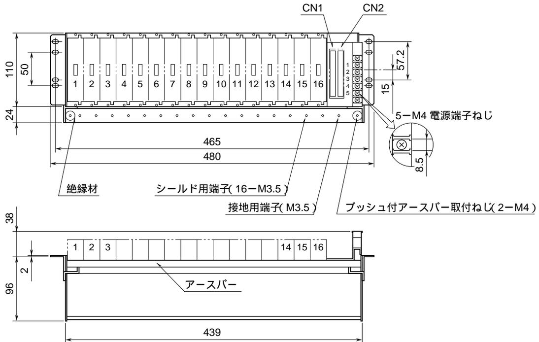
取付寸法図 (単位: mm)
