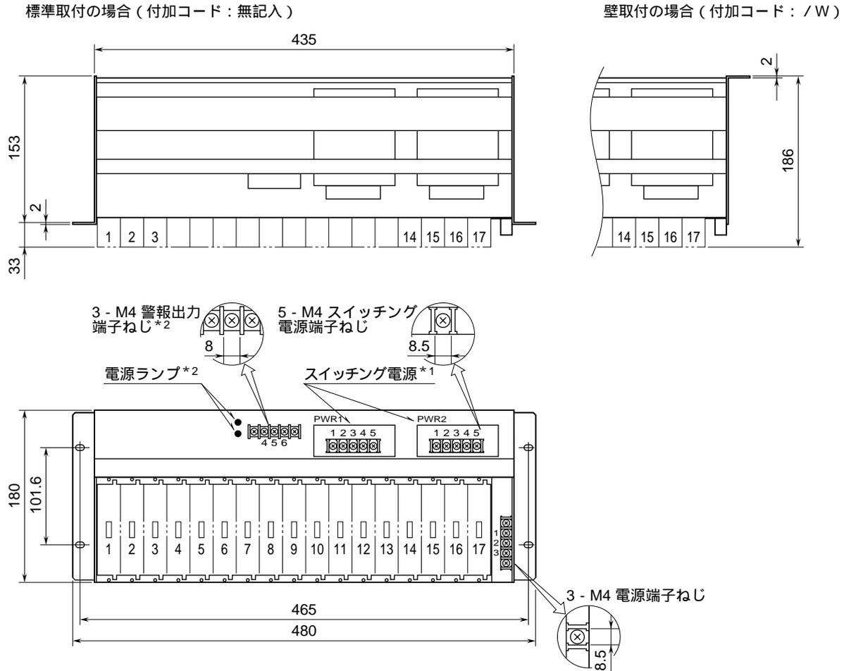
PV入力用として18-RACK変換器シリーズを収納するときは奇数スロットに収納し、その右側にDCSカードを収納して下さい。
