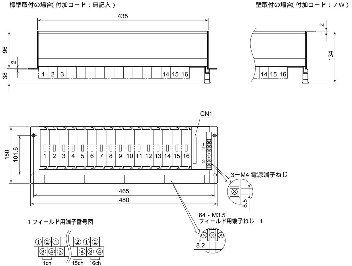
取付寸法図 (単位: mm)
