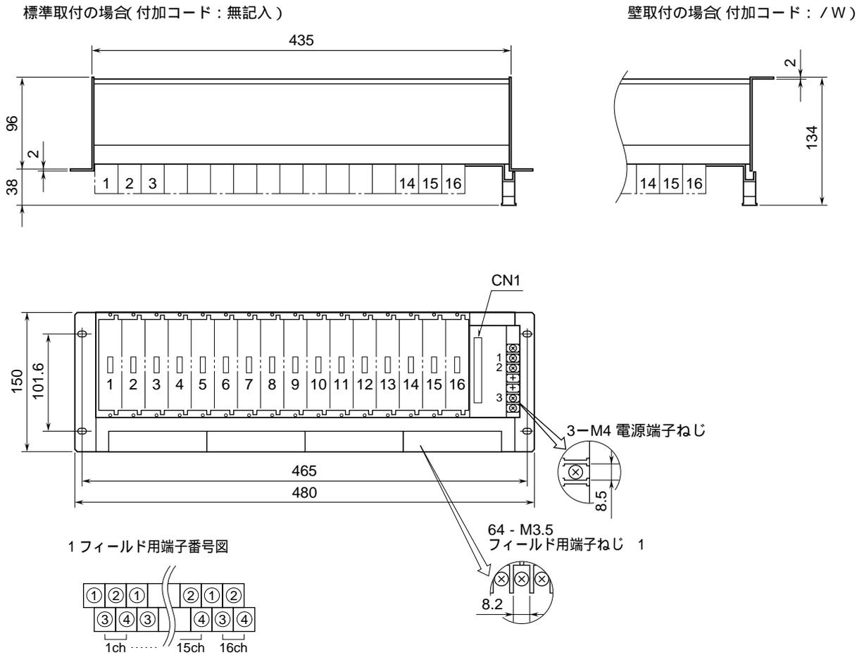
**取付寸法図 (単位: mm)**
