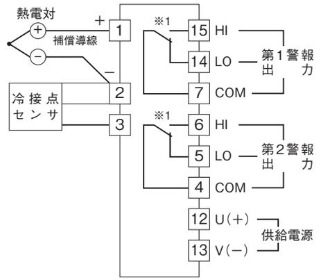
※1、警報出力コード“1、4”のときの電源OFF時の接点状態です。
