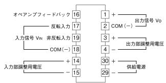
注) 入力部調整用電圧のコモンは入力信号COM(-)と共通です。 出力部調整用電圧のコモンは出力信号COM(-)と共通です。
